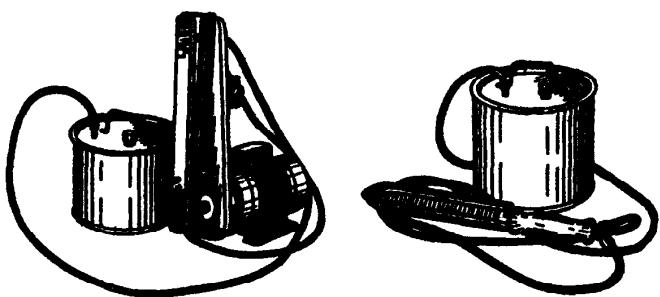
Вибромаж механический для распечатывания сотов (слева),
