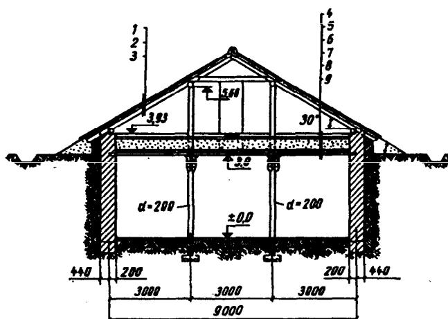
Поперечный разрез подземного зимовника на 250 пчелиных семей (стены из кирпича; размеры в мм):
