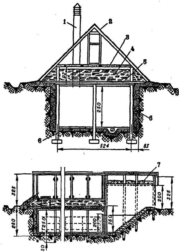
*Рис. 18. Подземный зимовник (перечный и продольный разрезы, размеры в см):*
