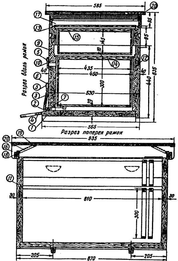
*Рис. 30. Схема устройства улья-лежака на 20 рамок:*
