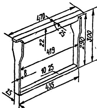
Рис. 23. Гнездовая рамка (размеры в мм)
