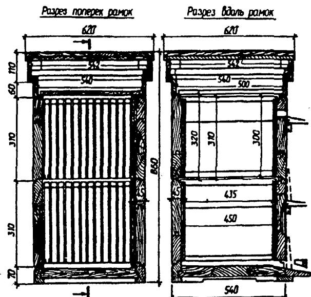
*Рис. 26. Схема устройства двухкорпусного улья*
