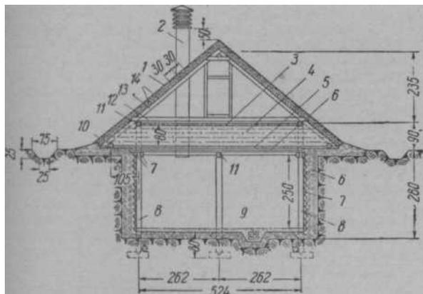
Рис. 1. Типовой подземный зимовник: 1 — глиносоломенная кровля; 2 — верхний вытяжной канал; 3 — слой сухой земли; 4 — утепляющий слой соломенной резки; 5 — песок; 6 — глина; 7 — пластины; 8 — стойка; 9 — приточный канал; 10 — лежень; 11 — прогон; 12 — ригель; 13 — стропила; 14 — жердевая обрешетка (размеры в см).
