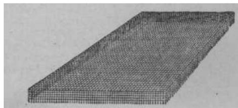
рис. 2. Самодельный колпачок из проволочной сетки.
