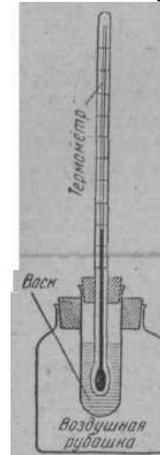
Рис. 2. Прибор для определения температуры застывания воска.
