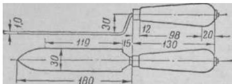
Рис. 2. Пчеловодный нож (детали устройства и размеры).
