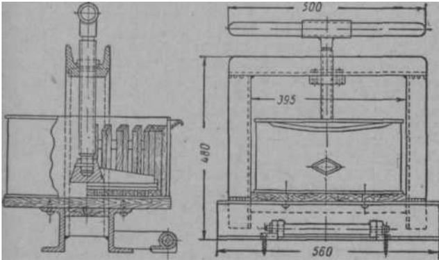
Рис. 2. Пасечный металлический воскопресс (по ГОСТ 5114-49).
