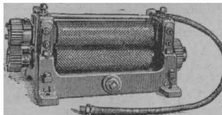
Рис. 2. Машинные гравированные вальцы с водяным охлаждением.
