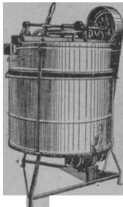
Рис. 4. Механизированная медогонка.
