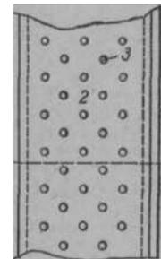
Рис. 2. Устройство приточного канала в зимовнике (под полом): 1 — канал; 2 — съёмная доска; 3 — отверстия в 25 мм.
