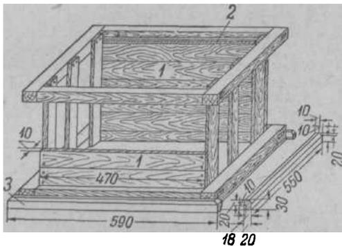
Рис. 1. Каркас корпуса соломенного улья в полусобранном виде: 1 — передняя и задняя стенки, каждая из сплошного настила досечек, расположенных в горизонтальном направлении; 2 — фальцы для навешивания рамок; 3 — наружные плиты, образующие вокруг корпуса борт (глубиной 10 мм), необходимый для соединения корпуса с дном и корпуса с корпусом.
