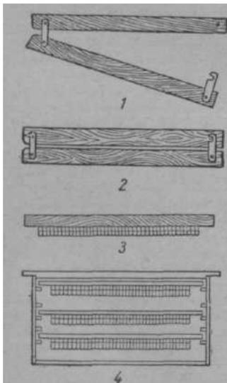
5. Маточная рамка Варфоломеева: 1 — линейка в раскрытом виде; 2 — линейка в закрытом виде; 3 — линейка с зажатой полоской ячеек (вид сбоку); 4 — маточная рамка с тремя ливейками-зажимами.
