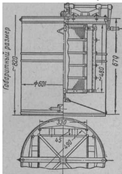
Рис. 1. Необорачивающаяся четырехрамочная медогонка (ГОСТ 5116-49) (схема).
