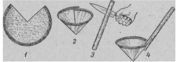
Изготовление черпака: 1 — круг с вырезом (уже обшитый по краям материей); 2 — тот же круг, но со стяннутыми краями; 3 — изготовленная ручка с расщепленным концом (зажимом); 4 — готовый черпак.
