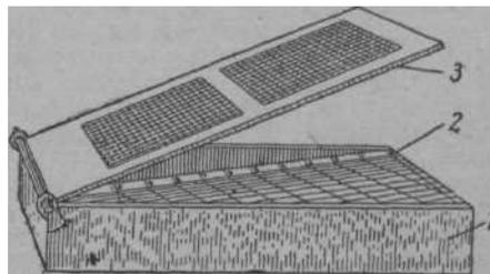
Глоссометр: 1 — резервуар; 2 — наклонное дно; 3 — крышка.
