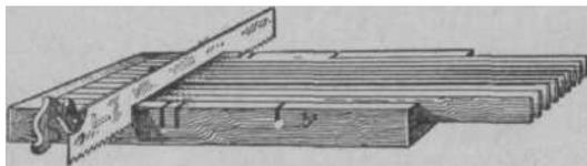
Рис. 2. Шаблон для заготовки рамочных брусков и планок.
