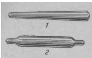
Рис. 1. Шаблон — палочка для изготовления мисочек: 1 — односторонний, 2 — двусторонний.
