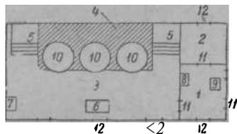
Схематический план медосливного пункта: 1 — приемная для меда; 2 — кладовая для хранения (переработанной) готовой продукции; 3 — отделение сортировочное; 4 — платформа для медоотстойников; 5 — лестница и площадка для подъема на платформу; 6 — лабораторный стол; 7 — хозяйственный стол; 8 — письменный стол; 9 — десятичные весы; 10 — медоотстойники; 11 — двери; 12 — окна.
