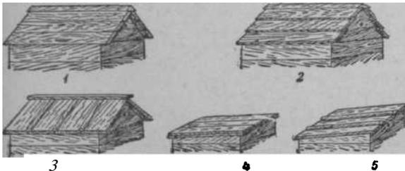
Типы крыш: 1 — 3 — двускатная крыша; 4 — 6 — односкатная крыша.
