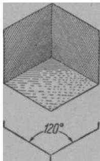
Рис. 3. Ячейка состоит из трех ромбиков, соединенных под углом 120° (вошина — «максимум») и 130° («полумаксимум»).
