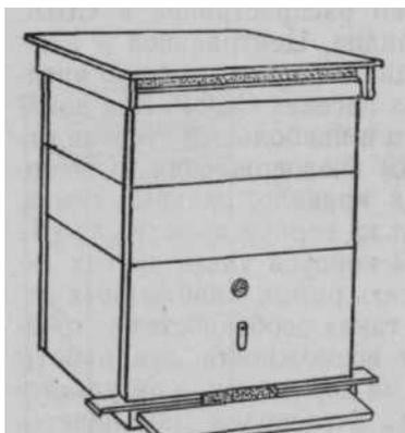
Двухкорпусный улей состоит из двух одинаковых корпусов, дна и крышки (рис. 13). Дно делается из досок толщиной 35 мм, собранных на брусках в виде щита. Оно наглухо прикрепляется к стенкам корпуса, который охватывает его с трех сторон. Со стороны передней стенки дно выступает на 35 мм. К этому выступу с помощью накладок крепится откидная прилетная доска, которую во время кочевки переводят в вертикальное положение и фиксируют вертушкой к корпусу улья.
