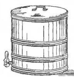
Рис. 4.47. Пасечный медоотстойник
