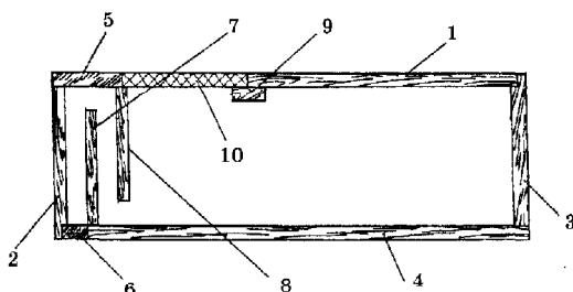
Рис. 9. Универсальная кормушка: 1 — крышка (6x235x278); 2 — передняя стенка (10x75x290); 3 — задняя стенка (10x75x290); 4 — дно (6x325x290); 5 — смотровое стекло; 6 — вставка (6x20x10); 7 — внутренняя нижняя (10x55x270); 8 — внутренняя верхняя (10x63x270); 9 — опорная планка (10x20x270); 10 — сетка для заливки сиропа. Боковая стенка — 10x75x330
