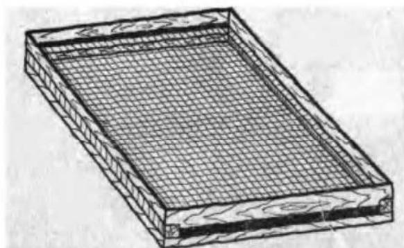
Рис. 33. Крыша улья с вентиляционным устройством.
